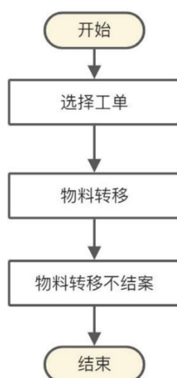
图 工单串行+平行生产处理流程图
